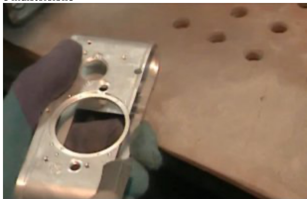
Il corpo di una Leica M6 in alluminio pressofuso rifinito a mano nello stabilimento portoghese
