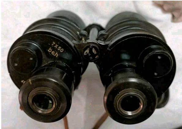
Senza rivestimento protettivo in gomma. Da notare come questi modelli, sia il 7x50 che l'8x60, fossero dotati di scomparti essiccatori – i due cilindri a fianco dell'oculare. Il modello 8x60 Leitz "beh" fu prodotto poco prima della fine della guerra, '44/'45
