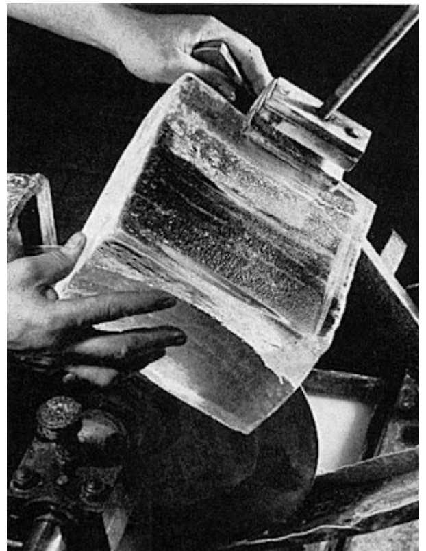
Una sega al diamante penetra nel blocco di vetro
