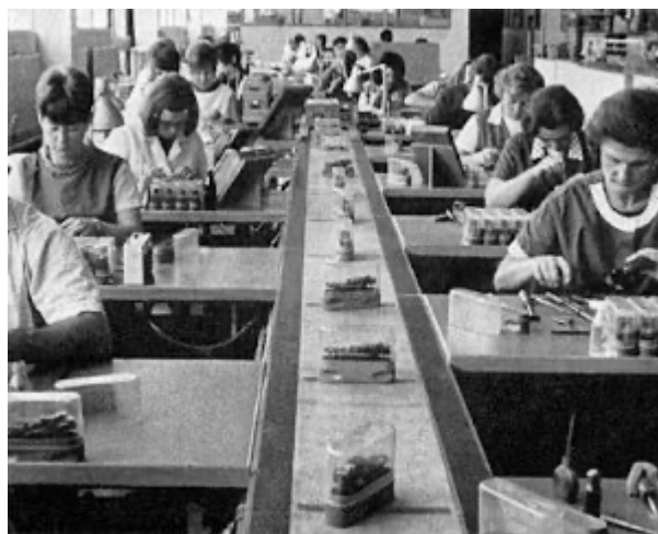
Assemblaggio dell'otturatore della Leica-M
