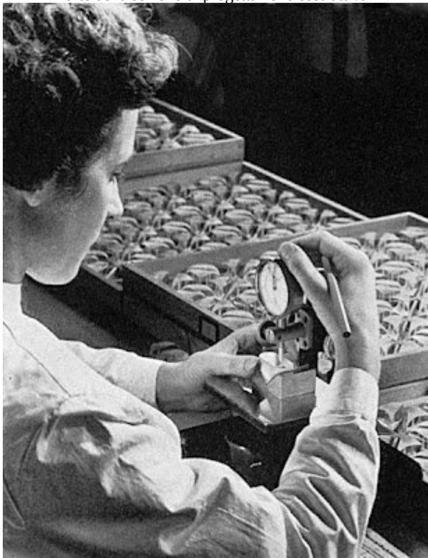
Verifica spessore prismi con calibro
