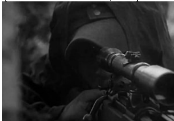
Cannocchiale ZF39 K98 H/4x60 Karl Kahles Wien, - “CAD”, con reticolo per calcolare le dimensioni/distanze; come dotazione alla carabina Mauser 98K, in configurazione standard da cecchino della Wehrmacht
