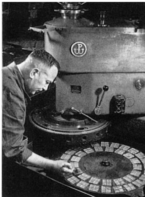
Piastre di vetro sulla macchina di macinazione, piano parallelo
