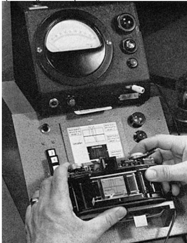
Test e regolazione del sinchro flash Leicaflex
