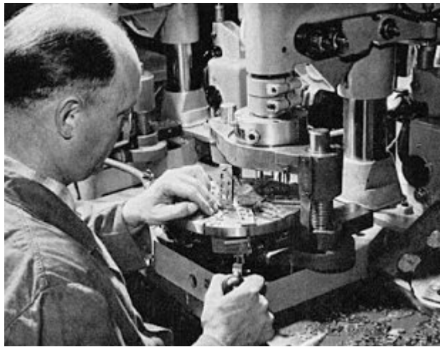
L'otturatore Leica viene perforato con la macchina multimandrino
