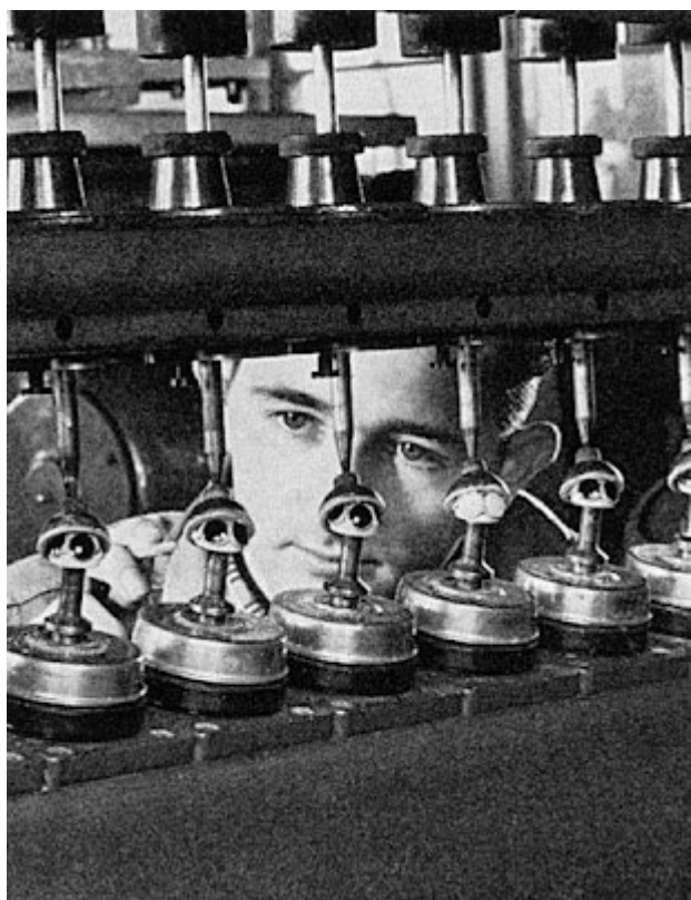
I blocchi di lenti sono levigati e lucidati con il multi-mandrino
