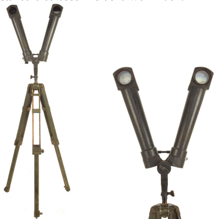
Periscopio di puntamento con ottica a orecchio di coniglio 10x50 Scherenferrohr S.F.14.Z.Gi. di Ernst Leitz “beh” con treppiede
