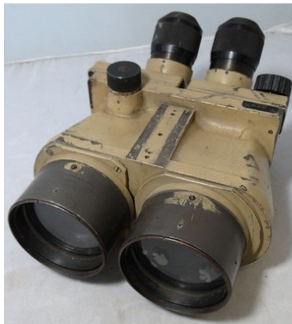
Binocolo da osservazione Leitz "beh" 45° 10 x 80 FLAK Doppelfernrohr (telescopio doppio) fu prodotto dal 1936 al 1945. Veniva montato su treppiedi per le sue dimensioni e peso. L'esemplare nella foto manca delle canne frontali che servivano da paraluce
